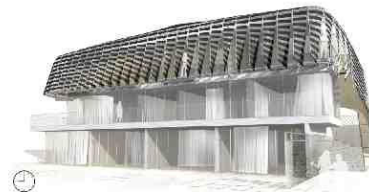
BEWEGLICHE TEXTILE DACHHAUT MIT PHOTOVOLTAIK SOLAR-PANEELEN
