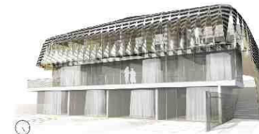
BEWEGLICHE TEXTILE DACHHAUT MIT PHOTOVOLTAIK SOLAR-PANEELEN
